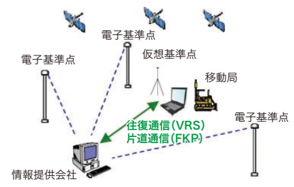
ネットワーク型RTK-GNSS
