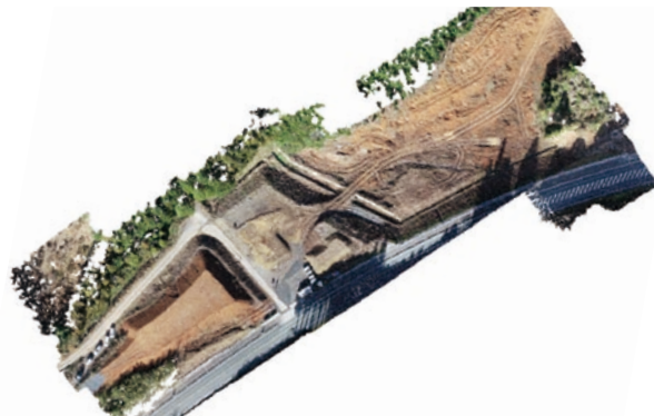
UAV写真測量の成果(点群データ) (一般国道490号(絵堂萩道路)絵堂IC)
