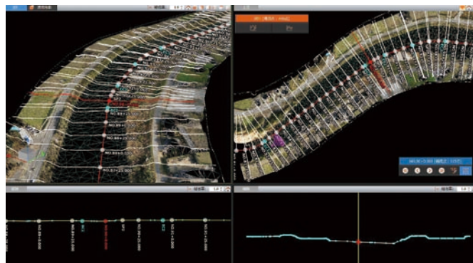
点群データから縦横断面図を作成
